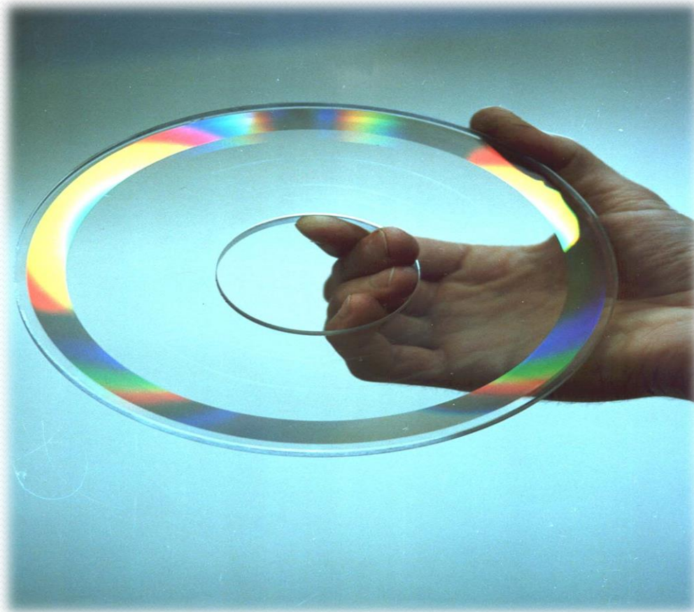
Фотография радиальной голографической решетки с 518.400 штрихами
