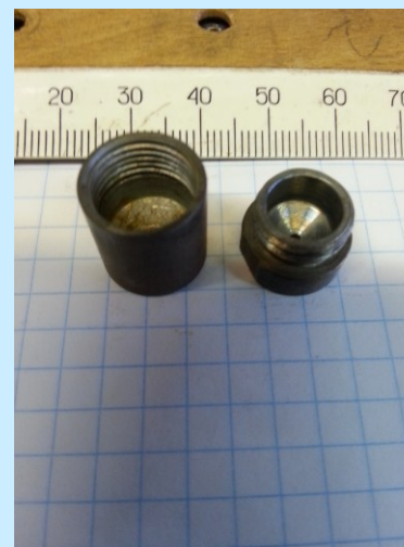
Капсула после полной возгонки мишенного вещества
